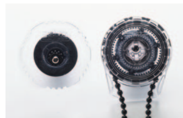
Embrayage démultiplié composé de rondelles cannelées rapport de 2.5 : 1
