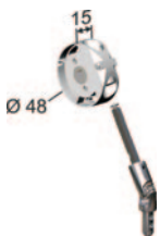
Détail des encombrements
